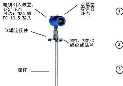
TDR100 系列变送器由变送器外壳、储罐连接件与探杆组成。只有探杆和连接件与储罐环境接触。变送器可配备各种探杆，以满足各种应用需求。
